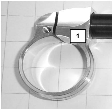
2. Beginnen Sie damit, die beiden Klemmen (1) mit den mitgelieferten Schrauben M8x40 DIN 912 (2) mittels beigefügtem Innensechskantschlüssel mit einem Drehmoment von 25 Nm an die Gabel anzulegen.
