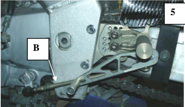
**Es ist unbedingt darauf zu achten, dass alle Teile der Fußrastenanlage immer einen Mindest-Abstand von 5 mm zu beweglichen Fahrzeugteilen haben, Kabel nicht scheuern.**
