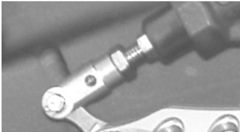
Adapter (C) auf den Bremszylinder schrauben, Bremshebelhöhe einstellen und Bolzen (D) von Rückseite einführen und mit Scheibe und Splint sichern.
