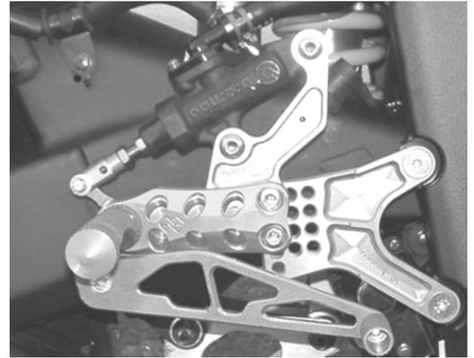
Grundplatten mit 2 Schrauben M8x25 am Rahmen befestigen. (Bei Y07-R6 Bj'03- zusätzlich mit Scheiben 20-8-6)
