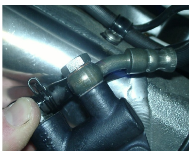
Bremsschlauchbefestigung am Bremszylinder nach 180° Drehung. Fastening break hose after twist the brake system to 180°
